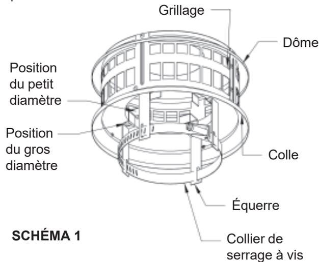
2. S'assurer que le capuchon d'évent universel est bien en place, au ras de la partie supérieure du tuyau. Serrez fermement le collier de serrage à vis autour de l'extérieur du tuyau. Voir le schéma 2. Pour le retirer, desserrez le collier de serrage à vis et soulevez le capuchon du tuyau.
